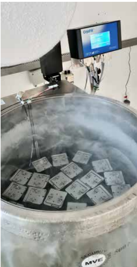
Voor het automatisch vullen en monitoren van de cryovaten maakt het Braziliaanse CryoForLife gebruik van de CryoFill vulautomaten van Cryo Solutions in combinatie met het XiltriX alarm- en monitoringsysteem.
